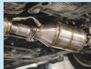
Catalizator montat pe țeava de eșapament
