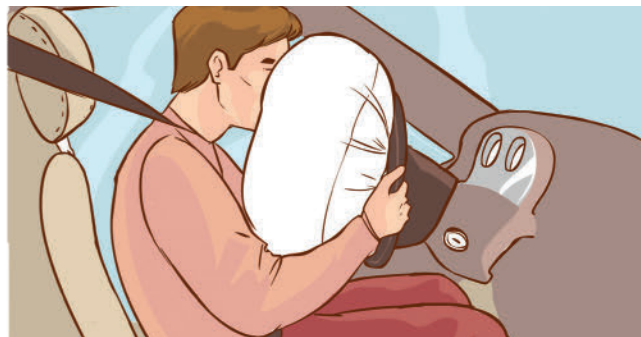
1. ábra: A légszák szerepe az ütközési erő csökkentésében
