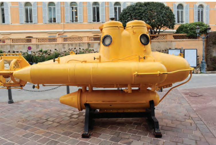
Fig. 2. Batiscaf, vehicul rezistent la presiunile enorme ale apelor oceanului.
